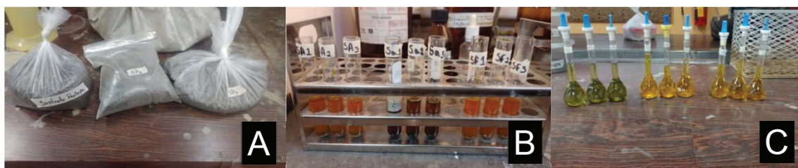
Figura 4. A) Muestras de suelos. B) Tubo de ensayo con suelo. C) Muestras aforadas en fiola de 25 mL.
