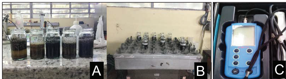
Figura 3. A) Envases con las mezclas de suelo-sustrato y agua destilada. B) Envases con las mezclas en el agitador. C) Equipo medidor CE (Hanna Hi 9811-5 portátil).
