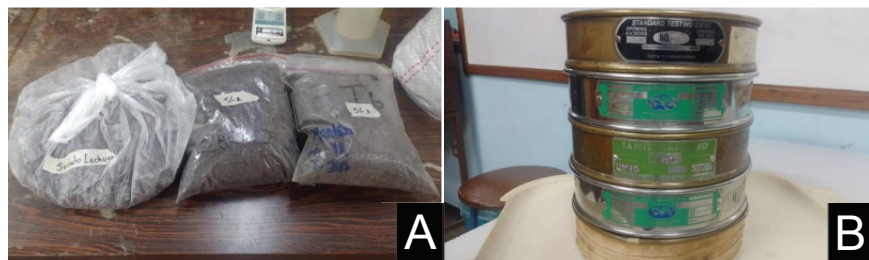
Figura 2. A) Muestras de sustratos B) Torre de tamices tamaños (16, 4, 2,1) mm.
